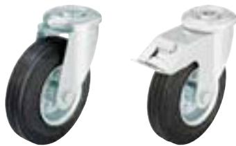
**Кронштейны:** серии LER - изготовлены методом штамповки из листовой стали, поворотный узел на двухрядном шарикоподшипнике, с прочным центральным стержнем, спрессован специальным, разработанным Blickle, динамическим методом, обеспечивающим путём холодной пластической деформации дорожек качения долговечность, минимальный люфт и лёгкость вращения, конструктивная защита шариков опорной панелью и опорной шайбой особой формы.
