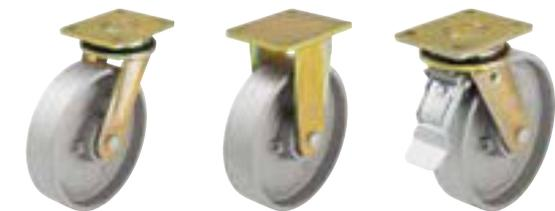
**Кронштейны:** серии LS/BS - особопрочная сварная конструкция из стали, поворотный узел на упорном шарикоподшипнике DIN 711 и коническом роликоподшипнике DIN 720, защищён от пыли и водяных брызг, со смазочным ниппелем, стянут очень стабильным сваренным центральным болтом с застопоренной гайкой. Ось колеса на болту. Гальванически оцинкованы с жёлтой пассивацией без содержания Cr6+.
