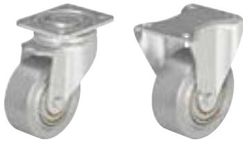
**Кронштейны:** серии LH/BH - изготовлены методом штамповки из толстостенной листовой стали, с массивной вилкой и крепёжной панелью, стянуты очень стабильным центральным болтом с застопоренной гайкой, поворотный узел на двухрядном шарикоподшипнике, усиленном дополнительно **четырьмя закалёнными вкладышами особой формы**, обеспечивающими особо высокую устойчивость к толчкам и ударам.
