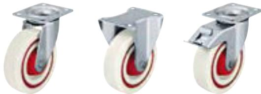
**Кронштейны:** серии LE/B - изготовлены методом штамповки из листовой стали, поворотный узел на двухрядном шарикоподшипнике, снабжён уплотнением, спрессован специальным, разработанным Blickle, динамическим методом, обеспечивающим путём холодной пластической деформации дорожек качения долговечность, минимальный люфт и лёгкость вращения. Ось колеса на болту.
