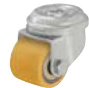
**Кронштейны:** серии LRA/LKRA - изготовлены методом штамповки из листовой стали, поворотный узел на двухрядном шарикоподшипнике, с прочным центральным стержнем, спрессован специальным, разработанным Blickle, динамическим методом, обеспечивающим путём холодной пластической деформации дорожек качения, минимальный люфт, лёгкость вращения и высокую долговечность.
