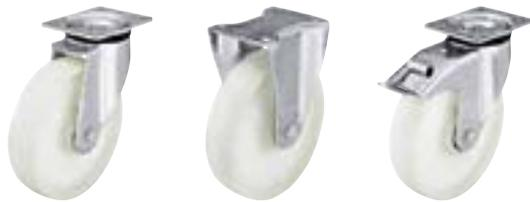
**Кронштейны:** Серия LK/BH - изготовлены методом штамповки из толстостенной листовой стали, поворотный узел на двухрядном шарикоподшипнике, с прочным центральным стержнем, снабжён уплотнением, спрессован специальным, разработанным Blickle, динамическим методом, обеспечивающим путём холодной пластической деформации дорожек качения долговечность, минимальный люфт и лёгкость вращения. Ось колеса на болту.
