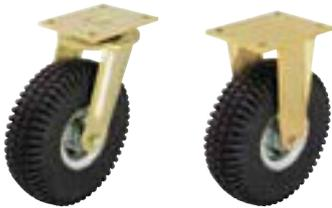
**Кронштейны:** серии LS/BS - особопрочная сварная конструкция из стали, поворотный узел на упорном шарикоподшипнике DIN 711 и коническом роликоподшипнике DIN 720, защищён от пыли и водяных брызг, со смазочным ниппелем, стянут очень стабильным сваренным центральным болтом с застопоренной гайкой. Ось колеса на болту. Гальванически оцинкованы с жёлтой пассивацией без содержания Cr6+. Обзорная информация о кронштейнах: на странице 68 Чертежи крепёжных панелей: на странице 78
