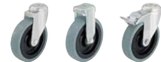
**Кронштейны:** серии LRA/BRA, LKRA/BKRA - изготовлены методом штамповки из листовой стали, поворотный узел на двухрядном шарикоподшипнике, с прочным центральным стержнем, спрессован специальным, разработанным Blickle, динамическим методом, обеспечивающим путём холодной пластической деформации дорожек качения долговечность, минимальный люфт и лёгкость вращения. Ось колеса на болту. Гальванически оцинкованы с голубой пассивацией без содержания Cr6+.
