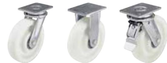
**Кронштейны:** серии LO/BO - надёжная стальная сварная конструкция, поворотный узел на двухрядном шарикоподшипнике, усиленном дополнительно **четырьмя закалёнными вкладышами особой формы**, с лабиринтным уплотнением и смазочным ниппелем, стянут очень стабильным вваренным центральным болтом с застопоренной гайкой.
