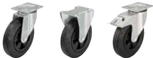
**Кронштейны:** серии L/B/BH - изготовлены методом штамповки из листовой стали, поворотный узел на двухрядном шарикоподшипнике, с прочным центральным стержнем (Ø колеса 160-250 мм), снабжён уплотнением, спрессован специальным, разработанным Blickle, динамическим методом, обеспечивающим путём холодной пластической деформации дорожек качения долговечность, минимальный люфт и лёгкость вращения. Ось колеса на болту. Гальванически оцинкованы с голубой пассивацией без содержания Cr6+.
