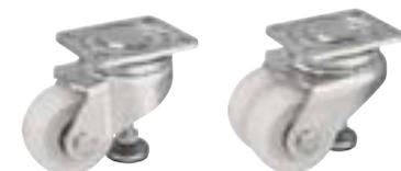
**Кронштейны:** Серия HRLH/HRLHD - изготовлены методом штамповки из толстостенной листовой стали, с массивной вилкой и крепёжной панелью, стянуты очень стабильным центральным болтом с застопоренной гайкой, поворотный узел на двухрядном шарикоподшипнике, усиленном дополнительно **четырьмя закалёнными вкладышами особой формы**, обеспечивающими особо высокую устойчивость к толчкам и ударам. Фиксирующая опора подъёмника из стали.
