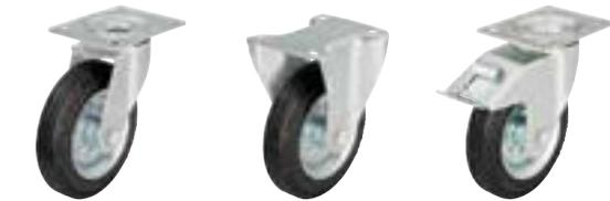
**Кронштейны:** серии LE/B - изготовлены методом штамповки из листовой стали, поворотный узел на двухрядном шарикоподшипнике, снабжён уплотнением, спрессован специальным, разработанным Blickle, динамическим методом, обеспечивающим путём холодной пластической деформации дорожек качения долговечность, минимальный люфт и лёгкость вращения. Ось колеса на болту. Гальванически оцинкованы с голубой пассивацией без содержания Cr6+.
