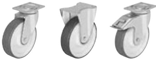
**Кронштейны:** серии LH/VH - изготовлены методом штамповки из толстостенной листовой стали, с массивной вилкой и крепёжной панелью, стянуты очень стабильным центральным болтом с застопоренной гайкой, поворотный узел на двухрядном шарикоподшипнике, усиленном дополнительно **четырьмя закалёнными вкладышами особой формы**, обеспечивающими особо высокую устойчивость к толчкам и ударам. Ось колеса на болту. Гальванически оцинкованы с голубой пассивацией без содержания Cr6+.
