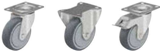
**Кронштейны:** серии LE/B - изготовлены методом штамповки из листовой стали, поворотный узел на двухрядном шарикоподшипнике, снабжён уплотнением, спрессован специальным, разработанным Blickle, динамическим методом, обеспечивающим путём холодной пластической деформации дорожек качения долговечность, минимальный люфт и лёгкость вращения. Ось колеса на болту.
