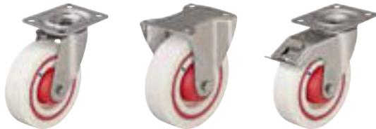
**Кронштейны:** серии LEX/BX - изготовлены методом штамповки из высококачественной нержавеющей хромоникелевой стали (номер стали 1.4301/AISI 304), поворотный узел на двухрядном шарикоподшипнике, снабжён уплотнением, спрессован специальным, разработанным Blickle, динамическим методом, обеспечивающим долговечность, минимальный люфт и лёгкость вращения. Все детали, включая элементы оси колеса, коррозионностойкие. Ось колеса на болту. Поверхность кронштейнов обработана вибрационным шлифованием.
