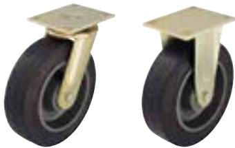
**Кронштейны:** серии LS/BS - особопрочная сварная конструкция из стали, поворотный узел на упорном шарикоподшипнике DIN 711 и коническом роликоподшипнике DIN 720, защищён от пыли и водяных брызг, со смазочным ниппелем, стянут очень стабильным сваренным центральным болтом с застопоренной гайкой. Ось колеса на болту. Гальванически оцинкованы с жёлтой пассивацией без содержания Cr6+.
