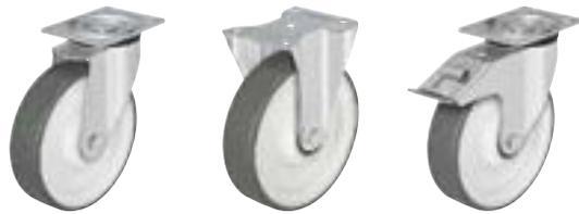
**Кронштейны:** серии L/B - изготовлены методом штамповки из листовой стали, поворотный узел на двухрядном шарикоподшипнике, с прочным центральным стержнем (Ø колеса 150-250 мм), снабжён уплотнением, спрессован специальным, разработанным Blickle, динамическим методом, обеспечивающим путём холодной пластической деформации дорожек качения долговечность, минимальный люфт и лёгкость вращения. Ось колеса на болту. Гальванически оцинкованы с голубой пассивацией без содержания Cr6+.
