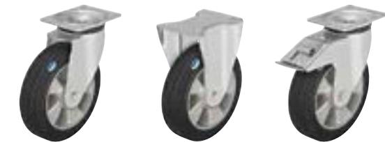
**Кронштейны:** серии LK/BK/BH - изготовлены методом штамповки из толстостенной листовой стали, поворотный узел на двухрядном шарикоподшипнике, с прочным центральным стержнем (Ø колеса 160-200 мм), снабжён уплотнением, спрессован специальным, разработанным Blickle, динамическим методом, обеспечивающим путём холодной пластической деформации дорожек качения долговечность, минимальный люфт и лёгкость вращения. Ось колеса на болту. Гальванически оцинкованы с голубой пассивацией без содержания Cr6+.
