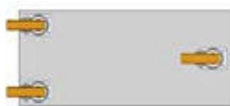
Три поворотных ролика одинаковой высоты
