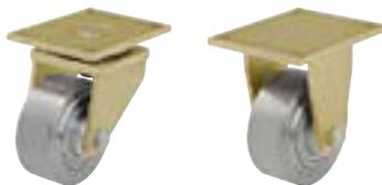
**Кронштейны:** серии LS/BS - особопрочная сварная конструкция из стали, поворотный узел на упорном шарикоподшипнике DIN 711 и коническом роликоподшипнике DIN 720, защищён от пыли и водяных брызг, со смазочным ниппелем, стянут очень стабильным сваренным центральным болтом с застопоренной гайкой. Ось колеса на болту.
