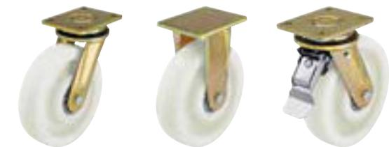
**Кронштейны:** серии LS/BS - особопрочная сварная конструкция из стали, поворотный узел на упорном шарикоподшипнике DIN 711 и коническом роликоподшипнике DIN 720, защищён от пыли и водяных брызг, со смазочным ниппелем, стянут очень стабильным вваренным центральным болтом с застопоренной гайкой. Ось колеса на болту. Гальванически оцинкованы с жёлтой пассивацией без содержания Cr6+.
