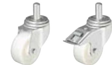
**Кронштейны:** серии LHZ - изготовлены методом штамповки из толстенной листовой стали, с массивной вилкой и опорной панелью, стянуты очень стабильной сваренной стальной цапфой с застопоренной гайкой, поворотный узел на двухрядном шарикоподшипнике, усиленном дополнительно **четырьмя закалёнными вкладышами особой формы**, обеспечивающими особо высокую устойчивость к толчкам и ударам.
