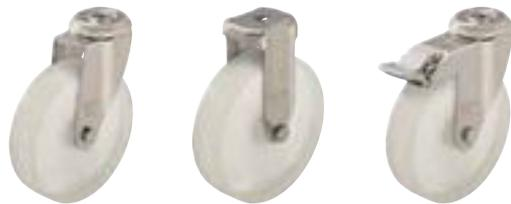
**Кронштейны:** серии LRXA/BRXA, LKRXA/VKRXA - изготовлены методом штамповки из высококачественной нержавеющей хромоникелевой стали (номер стали 1.4301/AISI 304), поворотный узел на двухрядном шарикоподшипнике, с прочным центральным стержнем, спрессован специальным, разработанным Blickle, динамическим методом, обеспечивающим долговечность и лёгкость вращения. Все детали, включая элементы оси колеса, коррозионностойкие.
