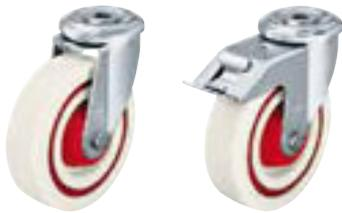
**Кронштейны:** серии LER - изготовлены методом штамповки из листовой стали, поворотный узел на двухрядном шарикоподшипнике, с прочным центральным стержнем, спрессован специальным, разработанным Blickle, динамическим методом, обеспечивающим путём холодной пластической деформации дорожек качения долговечность, минимальный люфт и лёгкость вращения, конструктивная защита шариков опорной панелью и опорной шайбой особой формы.
