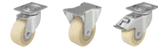
**Кронштейны:** серии LH/BH - изготовлены методом штамповки из толстостенной листовой стали, с массивной вилкой и крепёжной панелью, стянуты очень стабильным центральным болтом с застопоренной гайкой, поворотный узел на двухрядном шарикоподшипнике, усиленном дополнительно **четырьмя закалёнными вкладышами особой формы**, обеспечивающими особо высокую устойчивость к толчкам и ударам.
