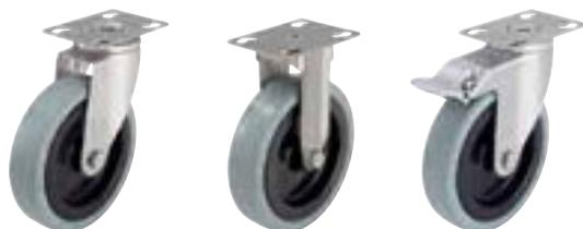
**Кронштейны:** серии LPXA/BPXA, LKPXA/BKPXA - изготовлены методом штамповки из высококачественной нержавеющей хромоникелевой стали (номер стали 1.4301/AISI 304), поворотный узел на двухрядном шарикоподшипнике, с прочным центральным стержнем, спрессован специальным, разработанным Blickle, динамическим методом, обеспечивающим долговечность и лёгкость вращения. Все детали, включая элементы оси колеса, коррозионностойкие.
