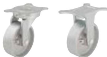
**Кронштейны:** серии LT/BT - из высококачественного ковкого чугуна, поворотный узел на двухрядном шарикоподшипнике (Ø колеса 65-80 мм: на однорядном шарикоподшипнике), конструктивная защита шариков крепёжной панелью и вилкой особой формы, со смазочным ниппелем.
