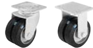
**Кронштейны:** серии LHD/BOD - у поворотных роликов: изготовлены методом штамповки из листовой стали, стянуты очень стабильным центральным болтом с застопоренной гайкой, поворотный узел на двухрядном шарикоподшипнике, усиленном дополнительно **четырьмя закалёнными вкладышами особой формы**, обеспечивающими особо высокую устойчивость к толчкам и ударам. У фиксированных роликов: надёжная стальная сварная конструкция.
