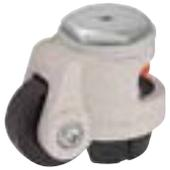
**Кронштейны:** серии HRIG - изготовлены методом литья под давлением из сплава алюминия, поворотный узел на уплотнённом шарикоподшипнике, с шестигранной стальной панелью, с внутренней резьбой в центральном крепёжном отверстии.
