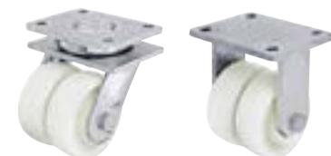
**Кронштейны:** серии LOD/BOD - надёжная стальная сварная конструкция, поворотный узел на двухрядном шарикоподшипнике, усиленном дополнительно **четырьмя закалёнными вкладышами особой формы**, с лабиринтным уплотнением и смазочным ниппелем, стянут очень стабильным вваренным центральным болтом с застопоренной гайкой. Ось колеса на болту. Гальванически оцинкованы с голубой пассивацией без содержания Cr6+.
