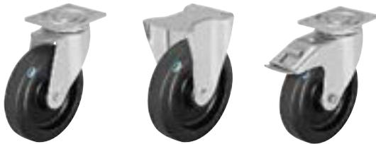
**Кронштейны:** серии LH/BH - изготовлены методом штамповки из толстостенной листовой стали, с массивной вилкой и крепёжной панелью, стянуты очень стабильным центральным болтом с застопоренной гайкой, поворотный узел на двухрядном шарикоподшипнике, усиленном дополнительно **четырьмя закалёнными вкладышами особой формы**, обеспечивающими особо высокую устойчивость к толчкам и ударам.
