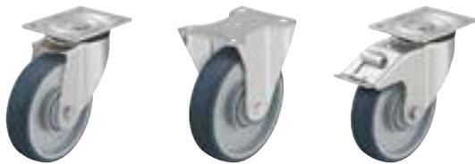
**Кронштейны:** серии L/B - изготовлены методом штамповки из листовой стали, поворотный узел на двухрядном шарикоподшипнике, с прочным центральным стержнем (Ø колеса 160-200 мм), снабжён уплотнением, спрессован специальным, разработанным Blickle, динамическим методом, обеспечивающим путём холодной пластической деформации дорожек качения долговечность, минимальный люфт и лёгкость вращения. Ось колеса на болту. Гальванически оцинкованы с голубой пассивацией без содержания Cr6+.
