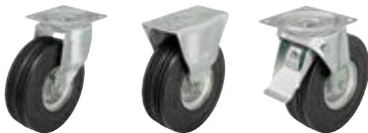
**Кронштейны:** серии L/B - изготовлены методом штамповки из листовой стали, поворотный узел на двухрядном шарикоподшипнике, с прочным центральным стержнем, спрессован специальным, разработанным Blickle, динамическим методом, обеспечивающим путём холодной пластической деформации дорожек качения долговечность, минимальный люфт и лёгкость вращения.
