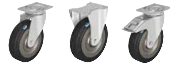
**Кронштейны:** серии LH/BH - изготовлены методом штамповки из толстостенной листовой стали, с массивной вилкой и крепёжной панелью, стянуты очень стабильным центральным болтом с застопоренной гайкой, поворотный узел на двухрядном шарикоподшипнике, усиленном дополнительно **четырьмя закалёнными вкладышами особой формы**, обеспечивающими особо высокую устойчивость к толчкам и ударам. Ось колеса на болту. Гальванически оцинкованы с голубой пассивацией без содержания Cr6+.
