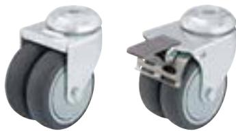
**Кронштейны:** серии LMDA - изготовлены методом штамповки из листовой стали, поворотный узел на двухрядном шарикоподшипнике с использованием заклёпочного соединения, защита шариков осуществляется опорной панелью и опорной шайбой особой формы. Ось колеса на болту. Гальванически оцинкованы с голубой пассивацией без содержания Cr6+.
