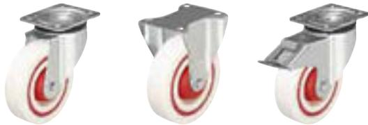
**Кронштейны:** серии LK/BK/ВН - изготовлены методом штамповки из толстостенной листовой стали, поворотный узел на двухрядном шарикоподшипнике, снабжён уплотнением, спрессован специальным, разработанным Blickle, динамическим методом, обеспечивающим путём холодной пластической деформации дорожек качения долговечность, минимальный люфт и лёгкость вращения.
