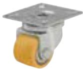
**Кронштейны:** серии LPA/LKPA - изготовлены методом штамповки из листовой стали, поворотный узел на двухрядном шарикоподшипнике, с прочным центральным стержнем, спрессован специальным, разработанным Blickle, динамическим методом, обеспечивающим путём холодной пластической деформации дорожек качения, минимальный люфт, лёгкость вращения и высокую долговечность.
