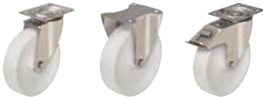
**Кронштейны:** серии LX/BX - изготовлены методом штамповки из высококачественной нержавеющей хромоникелевой стали (номер стали 1.4301/AISI 304), поворотный узел на двухрядном шарикоподшипнике, с прочным центральным стержнем, снабжен уплотнением, спрессован специальным, разработанным Blickle, динамическим методом, обеспечивающим долговечность и лёгкость вращения. Все детали, включая элементы оси колеса, коррозионностойкие.
