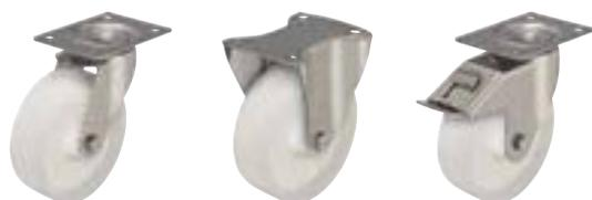
**Кронштейны:** серии LEX/BX - изготовлены методом штамповки из высококачественной нержавеющей хромоникелевой стали (номер стали 1.4301/AISI 304), поворотный узел на двухрядном шарикоподшипнике, снабжён уплотнением, спрессован специальным, разработанным Blickle, динамическим методом, обеспечивающим долговечность, минимальный люфт и лёгкость вращения. Все детали, включая элементы оси колеса, коррозионностойкие.
