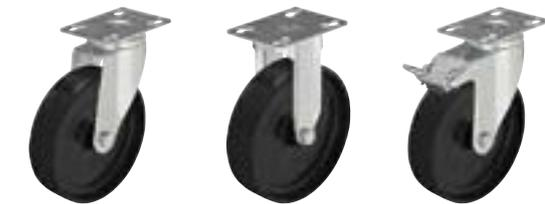
**Кронштейны:** серии LPA/BPA, LKPA/BKPA - изготовлены методом штамповки из листовой стали, поворотный узел на двухрядном шарикоподшипнике с прочным центральным стержнем, спрессован специальным, разработанным Blickle, динамическим методом, обеспечивающим путём холодной пластической деформации дорожек качения долговечность, минимальный люфт и лёгкость вращения. Ось колеса на болту. Гальванически оцинкованы с голубой пассивацией без содержания Cr6+.
