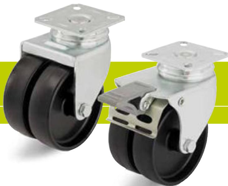
**Кронштейны:** серии LDA - изготовлены методом штамповки из листовой стали, поворотный узел на двухрядном шарикоподшипнике с использованием заклёпочного соединения, защита шариков осуществляется опорной панелью и опорной шайбой особой формы. Ось колеса на болту. Гальванически оцинкованы с голубой пассивацией без содержания Cr6+. Обзорная информации о кронштейнах: на странице 62 Чертежи крепёжных панелей: на странице 76 Фиксирующая система "stop-fix": на странице 80
