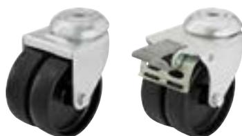
**Кронштейны:** серии LMDA - изготовлены методом штамповки из листовой стали, поворотный узел на двухрядном шарикоподшипнике с использованием заклепочного соединения, защита шариков осуществляется опорной панелью и опорной шайбой особой формы. Ось колеса на болту. Гальванически оцинкованы с голубой пассивацией без содержания Cr6+.
