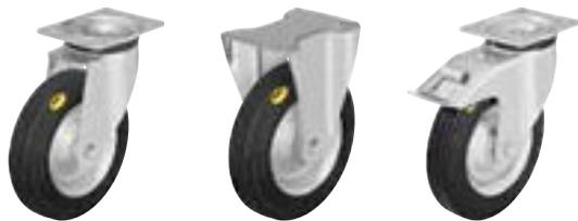
**Кронштейны:** серии LK/BK/BH - изготовлены методом штамповки из толстостенной листовой стали, поворотный узел на двухрядном шарикоподшипнике, с прочным центральным стержнем (Ø колеса 160-200 мм), снабжён уплотнением, спрессован специальным, разработанным Blickle, динамическим методом, обеспечивающим путём холодной пластической деформации дорожек качения долговечность, минимальный люфт и лёгкость вращения. Ось колеса на болту. Гальванически оцинкованы с голубой пассивацией без содержания Cr6+.
