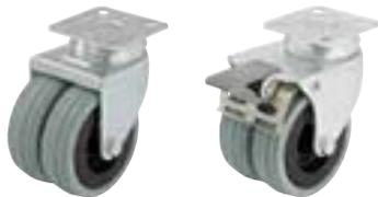
**Кронштейны:** серии LDA - изготовлены методом штамповки из листовой стали, поворотный узел на двухрядном шарикоподшипнике с использованием заклёпочного соединения, защита шариков осуществляется опорной панелью и опорной шайбой особой формы. Ось колеса на болту.
