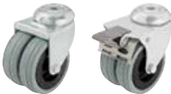
**Кронштейны:** серии LMDA - изготовлены методом штамповки из листовой стали, поворотный узел на двухрядном шарикоподшипнике с использованием заклёпочного соединения, защита шариков осуществляется опорной панелью и опорной шайбой особой формы. Ось колеса на болту.
