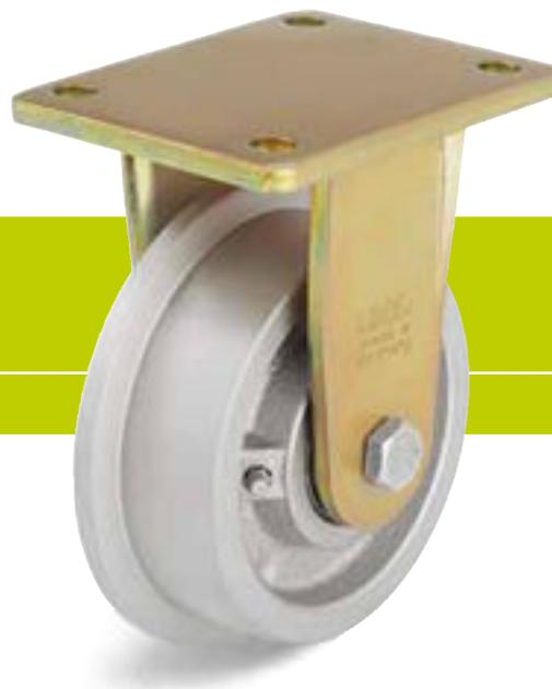
**Кронштейны:** серии BS - особо прочная стальная сварная конструкция со специально усиленными боковинами для лучшего восприятия осевых нагрузок. Ось колеса на болту. Гальванически оцинкованы с жёлтой пассивацией без содержания Cr6+.
