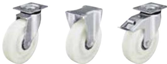
**Кронштейны:** серии LK/BK/ВН - изготовлены методом штамповки из толстостенной листовой стали, поворотный узел на двухрядном шарикоподшипнике, снабжён уплотнением, спрессован специальным, разработанным Blickle, динамическим методом, обеспечивающим путём холодной пластической деформации дорожек качения долговечность, минимальный люфт и лёгкость вращения.
