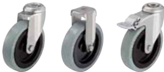
**Кронштейны:** серии LRXA/BRXA, LKRXA/BKRXA - изготовлены методом штамповки из высококачественной нержавеющей хромоникелевой стали (номер стали 1.4301/AISI 304), поворотный узел на двухрядном шарикоподшипнике, с прочным центральным стержнем, спрессован специальным, разработанным Blickle, динамическим методом, обеспечивающим долговечность и лёгкость вращения. Все детали, включая элементы оси колеса, коррозионностойкие.
