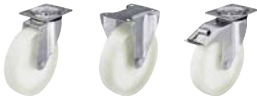
**Кронштейны:** серии L/B - изготовлены методом штамповки из листовой стали, поворотный узел на двухрядном шарикоподшипнике, с прочным центральным стержнем (Ø колеса 150-200 мм), снабжён уплотнением, спрессован специальным, разработанным Blickle, динамическим методом, обеспечивающим путём холодной пластической деформации дорожек качения долговечность, минимальный люфт и лёгкость вращения. Ось колеса на болту. Гальванически оцинкованы с голубой пассивацией без содержания Cr6+.
