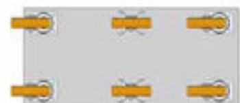
Четыре поворотных и два фиксированных ролика одинаковой высоты
