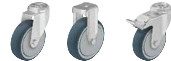
**Кронштейны:** серии LRA/BRA, LKRA/BKRA - изготовлены методом штамповки из листовой стали, поворотный узел на двухрядном шарикоподшипнике, с прочным центральным стержнем, спрессован специальным, разработанным Blickle, динамическим методом, обеспечивающим путём холодной пластической деформации дорожек качения долговечность, минимальный люфт и лёгкость вращения. Ось колеса на болту. Гальванически оцинкованы с голубой пассивацией без содержания Cr6+.
