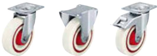
**Кронштейны:** серии L/B - изготовлены методом штамповки из листовой стали, поворотный узел на двухрядном шарикоподшипнике, снабжён уплотнением, спрессован специальным, разработанным Blickle, динамическим методом, обеспечивающим путём холодной пластической деформации дорожек качения долговечность, минимальный люфт и лёгкость вращения. Ось колеса на болту.
