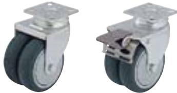
**Кронштейны:** серии LDA - изготовлены методом штамповки из листовой стали, поворотный узел на двухрядном шарикоподшипнике с использованием заклёпочного соединения, защита шариков осуществляется опорной панелью и опорной шайбой особой формы. Ось колеса на болту. Гальванически оцинкованы с голубой пассивацией без содержания Cr6+.
