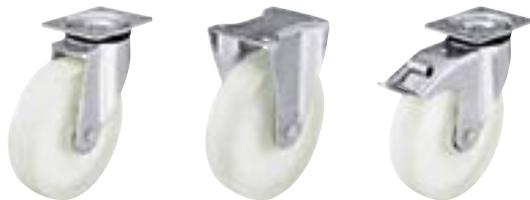
**Кронштейны:** серии LK/BK - изготовлены методом штамповки из толстостенной листовой стали, поворотный узел на двухрядном шарикоподшипнике, снабжён уплотнением, спрессован специальным, разработанным Blickle, динамическим методом, обеспечивающим путём холодной пластической деформации дорожек качения долговечность, минимальный люфт и лёгкость вращения.
