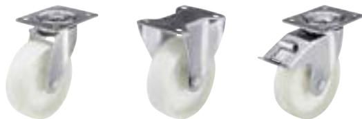
**Кронштейны:** серии LE/B - изготовлены методом штамповки из листовой стали, поворотный узел на двухрядном шарикоподшипнике, снабжён уплотнением, спрессован специальным, разработанным Blickle, динамическим методом, обеспечивающим путём холодной пластической деформации дорожек качения долговечность, минимальный люфт и лёгкость вращения. Ось колеса на болту.
