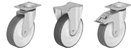
**Кронштейны:** серии LK/BK/BH - изготовлены методом штамповки из толстостенной листовой стали, поворотный узел на двухрядном шарикоподшипнике, с прочным центральным стержнем (Ø колеса 150-200 мм), снабжён уплотнением, спрессован специальным, разработанным Blickle, динамическим методом, обеспечивающим путём холодной пластической деформации дорожек качения долговечность, минимальный люфт и лёгкость вращения. Ось колеса на болту. Гальванически оцинкованы с голубой пассивацией без содержания Cr6+.
