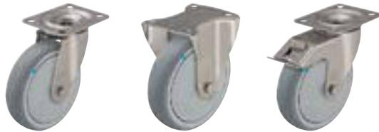
**Кронштейны:** серии LEX/BX - изготовлены методом штамповки из высококачественной нержавеющей хромоникелевой стали (номер стали 1.4301/AISI 304), поворотный узел на двухрядном шарикоподшипнике, снабжён уплотнением, спрессован специальным, разработанным Blickle, динамическим методом, обеспечивающим долговечность, минимальный люфт и лёгкость вращения. Все детали, включая элементы оси колеса, коррозионностойкие.
