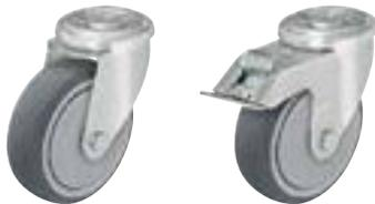
**Кронштейны:** серии LER - изготовлены методом штамповки из листовой стали, поворотный узел на двухрядном шарикоподшипнике, с прочным центральным стержнем, спрессован специальным, разработанным Blickle, динамическим методом, обеспечивающим путём холодной пластической деформации дорожек качения долговечность, минимальный люфт и лёгкость вращения, конструктивная защита шариков опорной панелью и опорной шайбой особой формы.
