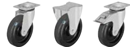
**Кронштейны:** серии LK/BK/BN - изготовлены методом штамповки из толстостенной листовой стали, поворотный узел на двухрядном шарикоподшипнике, с прочным центральным стержнем (Ø колеса 160-200 мм), снабжён уплотнением, спрессован специальным, разработанным Blickle, динамическим методом, обеспечивающим путём холодной пластической деформации дорожек качения долговечность, минимальный люфт и лёгкость вращения. Ось колеса на болту. Гальванически оцинкованы с голубой пассивацией без содержания Cr6+.
