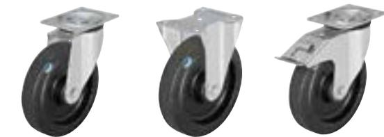
**Кронштейны:** серии L/B/BH - изготовлены методом штамповки из листовой стали, поворотный узел на двухрядном шарикоподшипнике, с прочным центральным стержнем (Ø колеса 160-250 мм), снабжён уплотнением, спрессован специальным, разработанным Blickle, динамическим методом, обеспечивающим путём холодной пластической деформации дорожек качения долговечность, минимальный люфт и лёгкость вращения. Ось колеса на болту. Гальванически оцинкованы с голубой пассивацией без содержания Cr6+.
