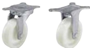
**Кронштейны:** серии LT/BT - из высококачественного ковкого чугуна, поворотный узел на двухрядном шарикоподшипнике ( $\emptyset$  колеса 75 мм: на однорядном шарикоподшипнике), конструктивная защита шариков крепёжной панелью и вилкой особой формы, со смазочным ниппелем.
